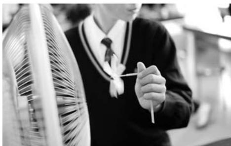
各自作製した風車の回り具合を確認中。扇風機の真横に立ち、安定的に回る位置を探しながら風車をかざす。扇風機の風量は予め固定しておく。このときの結果を元に各班で協力して1つの風車を作製し、回転数コンテストを行うことになる。既存のものに改良を加えたり、新規に設計をし直したり、各班思い思いの風車を完成させた。
